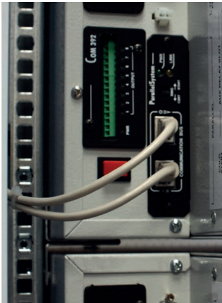
Parallelkonfiguration und programmierbare Relaiskarte
